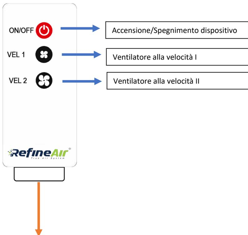
Per poter utilizzare il comando IR, è necessario rimuovere la linguetta indicata
