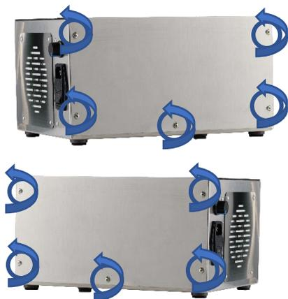
Per poter effettuare un'ispezione visiva del dispositivo, è necessario svitare le viti presenti ai lati della calotta e successivamente sollevarla verso l'alto.
