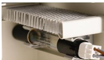
**Sostituzione della lampada dopo 10.000 ore di utilizzo**
