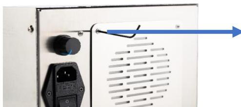
Per effettuare le operazioni di manutenzione del filtro al biossido di titanio, svitare la griglia con una chiave esagonale
