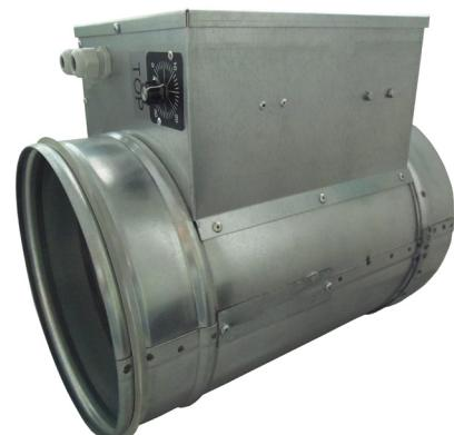
La temperatura in uscita è controllata in continuo da una sonda a corredo ed è regolabile tramite un potenziometro posto all'interno della scatola di comando con una range da 0 a 30°C.
